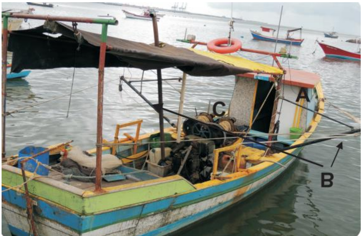
Figura 3. Bote camaroeiro artesanal, onde destaca-se a casaria a vante (A), os tangones (B) e o guincho (C) e motor central. Fonte: (BANNWART, 2014)
