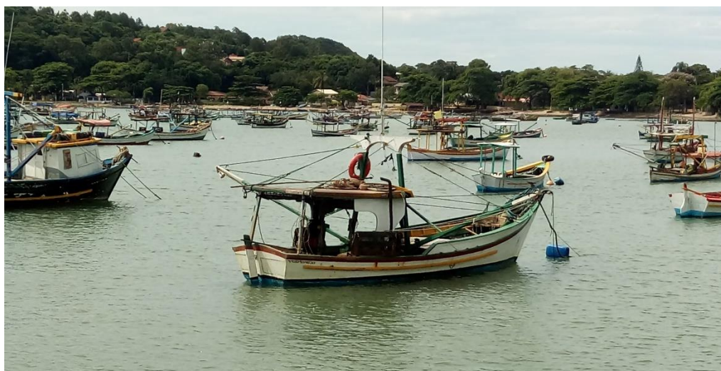
Figura 1. Embarcação do tipo bote boca aberta, com toldo e sem casaria ancorada na Armação do Itapocoroy Penha/SC. Fonte: da autora
